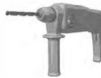
Bohrmaschine mit 6er Bohrer
